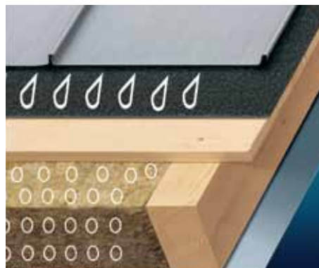
Pare-pluie respirant AEROPLUS Claire-Voie associé à l'isolant Isonat Fiberwood Multisol
